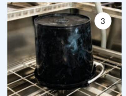
1: Kammerhalter für Galluskammern, 2: Kammerhalter für Nilpeter-Kammer, 3: Zum Reinigen von Eimern können rotierende Düsen auf das Gitter gestellt werden.
