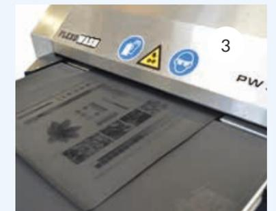
1: Anstelle einer Wanne können Sie einen Tisch zum Entladen der Platten hinzufügen. 2: Schwammwalzenhalter zur einfachen und sicheren Aufbewahrung des Schwamms gegen Austrocknen bei längerer Nichtbenutzung, 3: Mit der DLE-Version können Sie lasergraviierte Platten reinigen.
