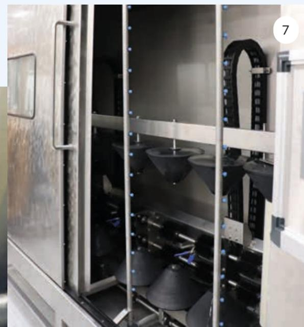
1. Beim Reinigen mehrerer Sleeves spülen die Hochdruckwasserdüsen die Hülsen sanft ab, bevor der Luftstrom die Oberfläche trocknet.
