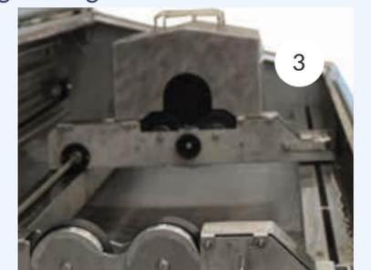
1: Für Rasterhülsen kann ein Adapter nach den spezifischen Maßen des Rastersleeve hergestellt werden. 2: Rezirkulationseinheit zur Wiederverwendung von Spülwasser. 3: Getriebeabdeckungen zum Schutz von Wellenenden.
