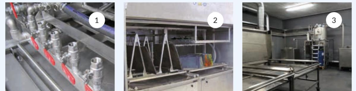
1: Reinigung von Schläuchen 2: Gestelle für Farbwanne, Zylinder und Rake, 3. Destillationssysteme und Integration zwischen Teileraschanlage, Tanks und Destillator.
