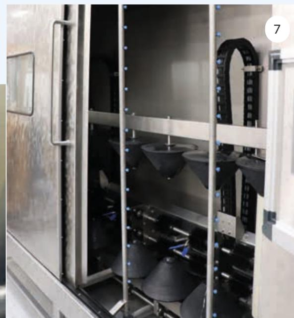
1. Lors du nettoyage de plusieurs manchons, les buses d'eau haute pression rincent doucement les manchons avant que le flux d'air ne sèche la surface.
