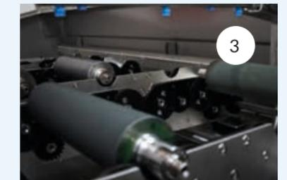
1: Para las mangas anilox, se puede hacer un adaptador según las medidas específicas del anilox. 2: Para los rodillos anilox, las unidades pueden fabricarse con cubiertas de engranajes para proteger los ejes. 3: Al añadir estaciones de tracción adicionales en las unidades FW 993, puede lavar hasta 9 aniloxes en un solo ciclo de limpieza.
