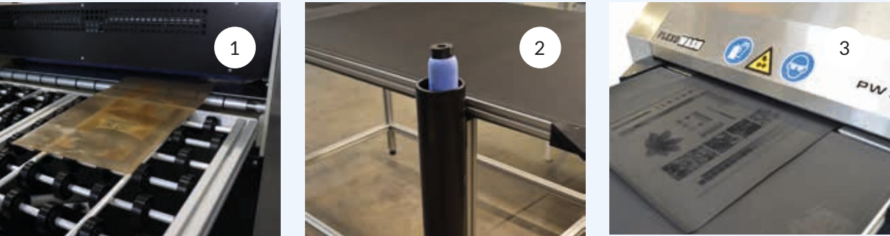
1: Anstelle einer Wanne können Sie einen Tisch zum Entladen der Platten hinzufügen. 2: Schwammwalzenhalter zur einfachen und sicheren Aufbewahrung des Schwamms gegen Austrocknen bei längerer Nichtbenutzung, 3: Mit der DLE-Version können Sie lasergravierte Platten reinigen.
