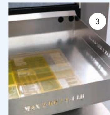
1. La table d'entrée transporte le cliché dans l'unité de nettoyage, ce qui permet de préparer plusieurs clichés pour le nettoyage à la fois.
