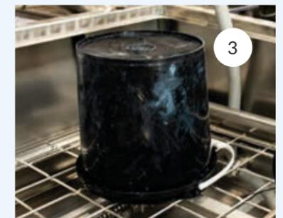
1: Soporte de cámara para cámaras Gallus, 2: Soporte de cámara para cámara Nilpeter, 3: Se pueden colocar boquillas giratorias en la rejilla para la limpieza de los cubos.
