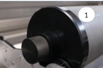
1 : Pour les manchons anilox, un adaptateur peut être réalisé selon les mesures spécifiques de l'anilox 2 : Unité de recirculation pour la réutilisation de l'eau de rinçage, 3 : Couvercles de roulements et pignons pour la protection des extrémités d'arbres.
