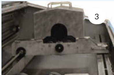
1 : Pour les manchons anilox, un adaptateur peut être réalisé selon les mesures spécifiques de l'anilox 2 : Unité de recirculation pour la réutilisation de l'eau de rinçage, 3 : Couvercles de roulements et pignons pour la protection des extrémités d'arbres.
