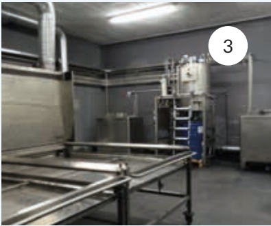
1: Limpieza de mangueras 2: Estanterías para bandejas de tinta y rasquetas, 3. Sistemas de destilación e integración entre la lavadora de piezas, los tanques y el destilador.
